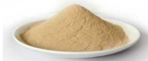
工业级碳酸锰在电解铅锌冶炼中通过优化电解液性能、抑制副反应和提升金属质量，成为重要的辅助添加剂。
